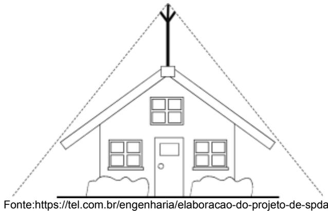
Este método se baseia no uso de captores pontiagudos colocados em mastros verticais para se aproveitar os efeitos das pontas, quanto maior a altura maior o volume protegido, volume este que tem a forma de um cone formado pelo triangulo retângulo girado em torno do mastro.
